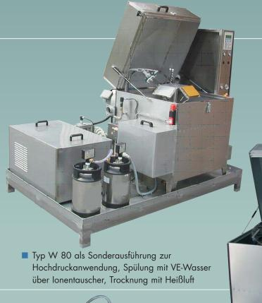
Beispiel für die Aufnahme einer Farbabfüllvorrichtung zur Entfernung von Farbe mit anschließender Spülung
