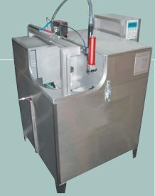
Typ RT Rundtakt-Reinigungsautomat mit Roboterbeschickung für die Einzelaufnahme von Automatenteilen
